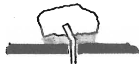
Saldatura sollevata della pista di rame.
