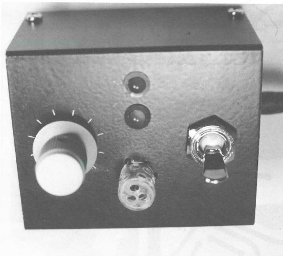
Apparecchio racchiuso nel contenitore: sul pannello troviamo il sensore, il commutatore, l'interruttore generale ed i visualizzatori a led.
